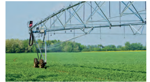
Fordulatszám szabályozású meghajtás a folyamatos haladás, és ezáltal a pontos vízkijuttatás érdekében.
