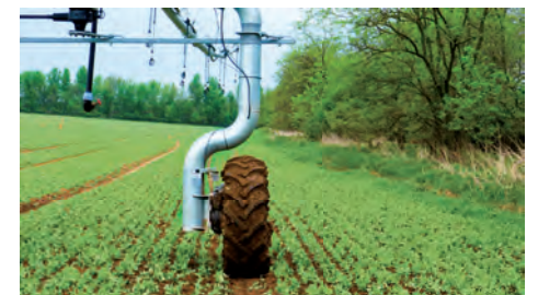
Pontos irányítás az indukciós vezérlésnek és az elforgatható kerekeknek köszönhetően.
