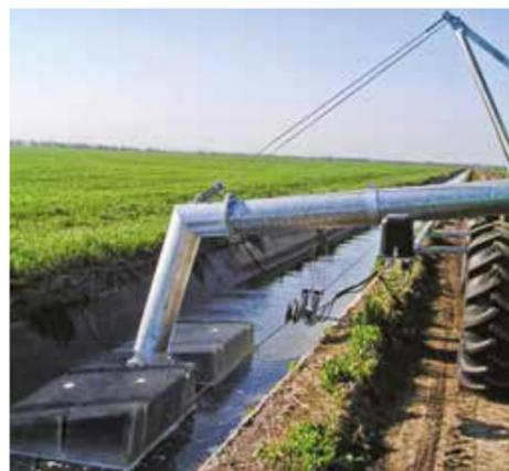
Solución individual: conducto de aspiración flotante
