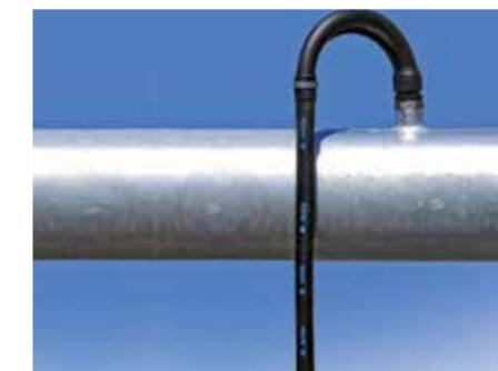
Las salidas de boquilla estables, de acero inoxidable V4A de alta calidad, garantizan una vida útil extraordinariamente prolongada. Las conexiones, de diseño especial, aportan una alta estabilidad y permiten el montaje de tubos de boquilla sin soportes adicionales.
