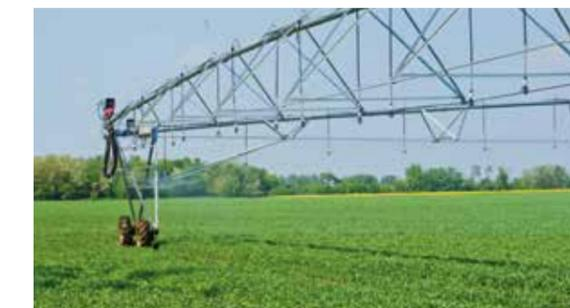
Accionamiento regulado mediante par para un avance continuado y, de este modo, una distribución exacta del agua.
