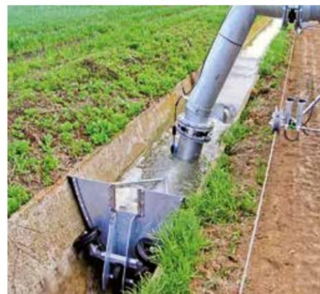
Conducto de aspiración con compuerta de retención
