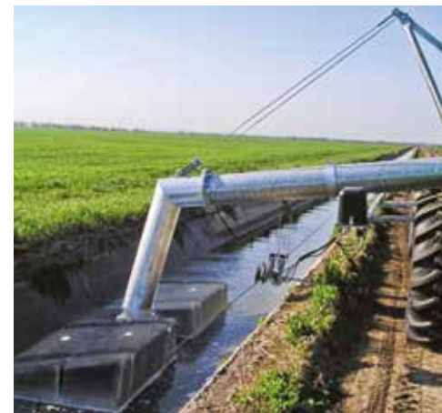
Individuelle Lösung: Schwimmsaugleitung
