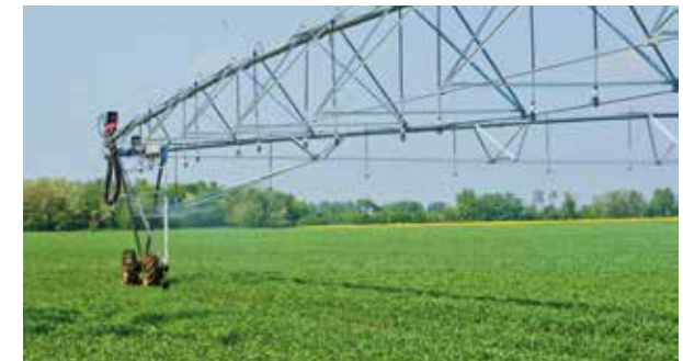
Drehzahl geregelter Antrieb für kontinuierlichen Vortrieb und damit exakte Wasserverteilung.
